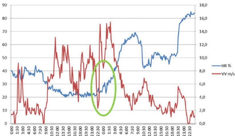
FIGURA 3.27 Velocidade do vento máxima e humidade relativa do ar (intervalos de 10 minutos) na estação meteorológica de Nelas (IPMA), durante os dias 15 e 16 de outubro de 2017. A elipse assinala a coincidência entre a velocidade mínima do vento, que antecede os valores máximos, e o início da subida da humidade do ar.
